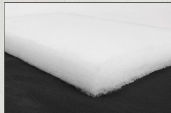
Dämmung für Akustikwände: 30 mm Isolation „Caruso WLG40“ und schwarzer Dämmvlies.
