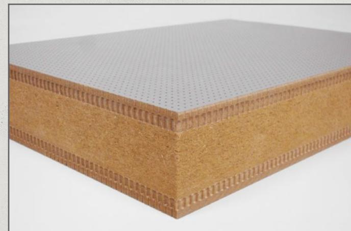
Akustiktrennwand: beidseitig 9,5 mm MDF mikroperforiert, 30 mm Kern – Holzfaserplatte.
